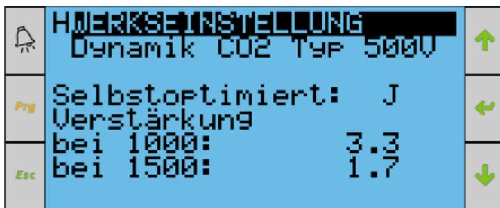
[Abbildung: Werkseinstellung im Menü > Regler, Anzeige für Verstärkung]
