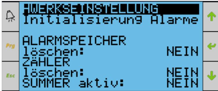
[Abbildung: Alarmhistorie Löschen im Menü > Einstellungen > Initialisierung]
