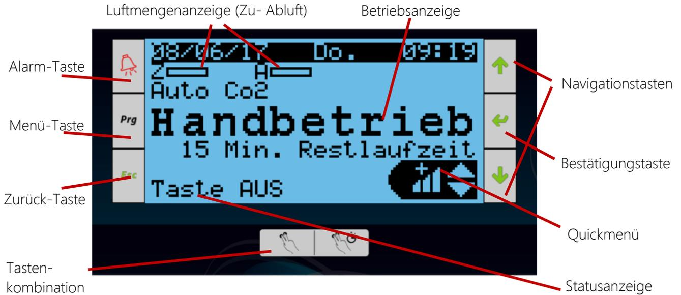
[Abbildung: Hauptanzeige und Tasten-Position von Browser-Webansicht-des Bedienteil]
