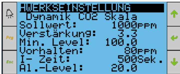
[Abbildung: Werkseinstellung im Menü > Regler, Anzeige für Dynamik]
